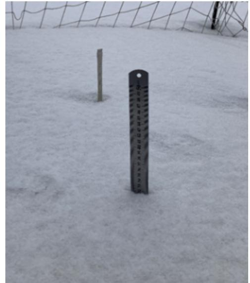
Рисунок 3. Измерительная линейка и термокоса, 10 утра 13.03.2024 года
