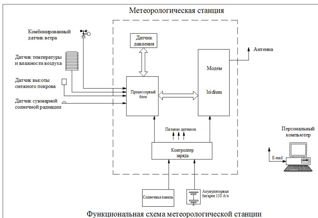
Рисунок 4. Функциональная схема метеорологической станции
