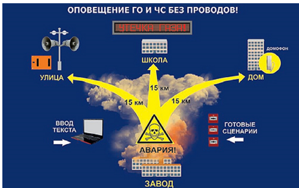
Рисунок 1. В условиях ЧС существует высокий риск повреждения кабельных линий связи. И в этом случае оптимальным решением является выделенный для нужд МЧС России радиоканал
