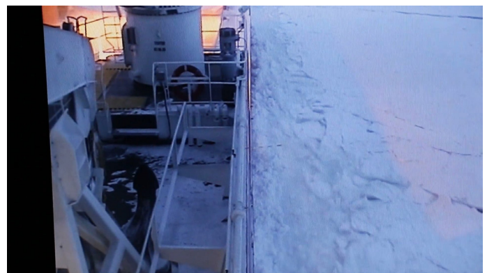
Рис. 8. Облипание корпуса судна снежно-ледяной массой в Татарском проливе
