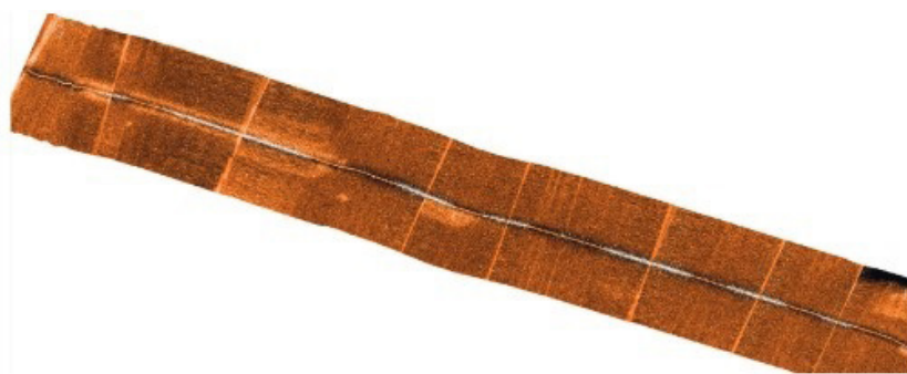
Рисунок 9 - Трек движения буксируемого объекта, построенный по данным системы подводного позиционирования, работающей в неблагоприятных погодных условиях [3]
