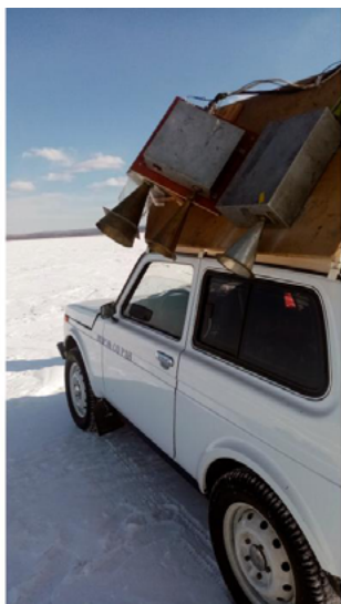
Рисунок 1. Фотография радиометрического комплекса на длины волн 2,3 см, 3 см, 5,6 см, установленного на автомобиль
