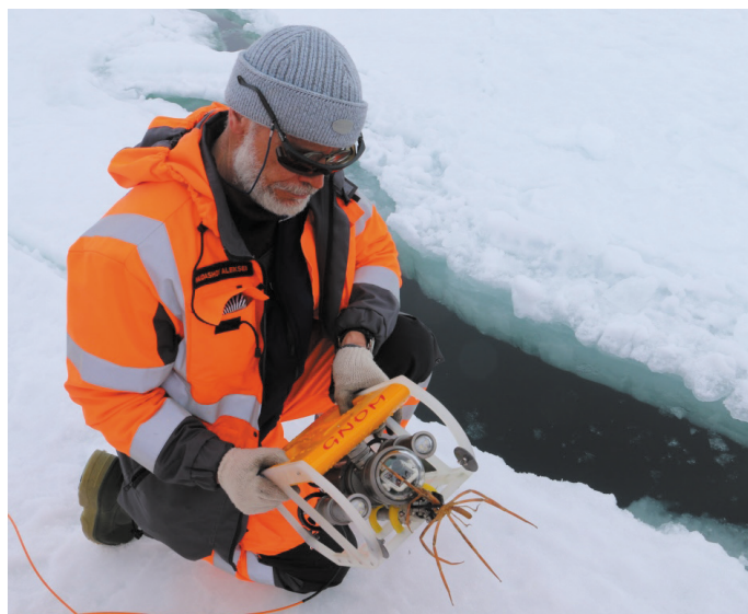
Отбор проб морских донных организмов с помощью беспилотного подводного аппарата.
