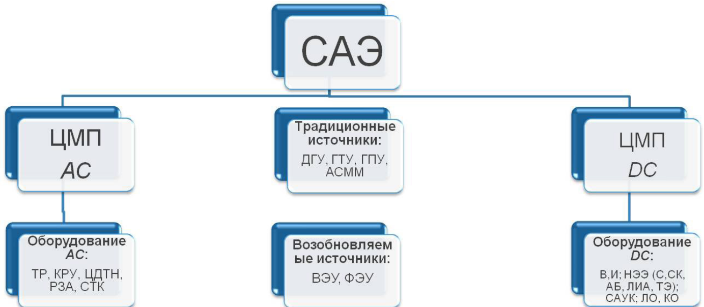
Рисунок 1 – Структура САЭ с использованием источников, ЦМП АС и ЦМП DC для Арктики Обозначения: АС – переменный ток; ДГУ – дизель-генераторное устройство; ГТУ – газотурбинное устройство; ГПУ – газопоршневое устройство; АСММ – атомная станция малой мощности; DC – постоянный ток; ТР – трансформатор; КРУ – комплектное распределительное устройство; ЦДТН – цифровой датчик тока и напряжения; РЗА – релейная защита и автоматика; СТК – статический тиристорный компенсатор; ВЭУ – ветровая электроустановка; ФЭУ – фотоэлектрическая установка; В, И – выпрямитель, инвертор; НЭЭ – накопители электроэнергии; С, СК – конденсатор, суперконденсатор; АБ – аккумуляторная батарея; ЛИА – литий-ионный аккумулятор; ТЭ – топливный элемент; САУК – система автоматического управления комплекса; ЛО, КО – лазерное и кинетическое оружие.
