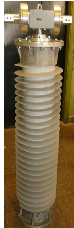
Рисунок 5 – ЦДТН: а) структурная схема; б) фотография [10].
